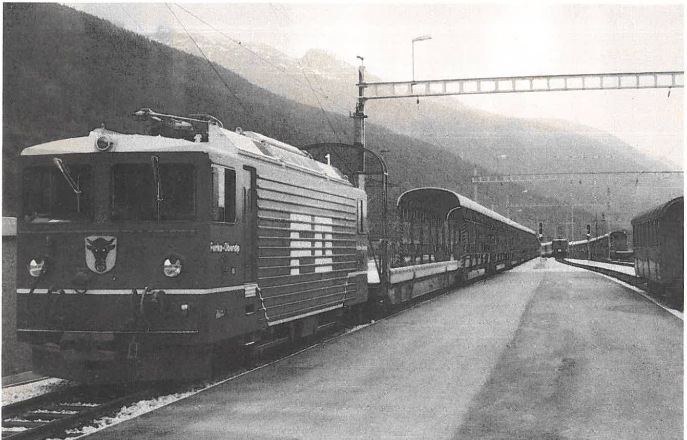
Nach Fertigstellung des Basistunnels werden auf der Schmalspurstrecke der Furka-Oberalp-Bahn auch Autotransportzüge verkehren. Im Bild Ellok 82 mit einem Rampenwagen (über den die Autos auf den Zug fahren) und mehreren Autotransportwagen. Am anderen Zugende läuft ein Steuerwagen mit Fahrgastabteilen, so daß ein echter Wendezugbetrieb möglich sein wird. Foto: Robert Münzing
